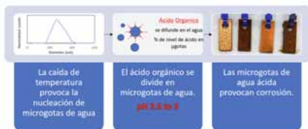
Figura 6. T: Efecto cambio de temperatura y nucleación de microgotas de agua.
