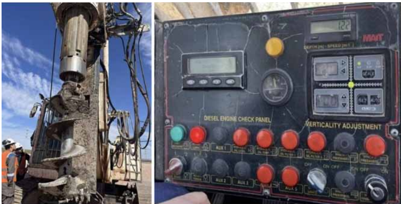
Imagen 16. Desvío con torre maquina pilotera con placa niveladora.
