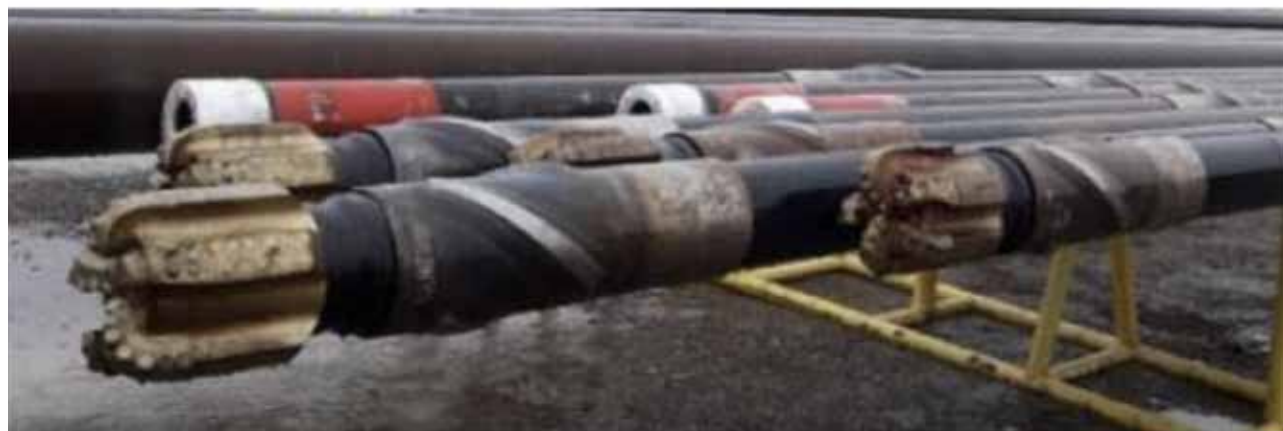
Imagen 26. Centralizadores en casing.
