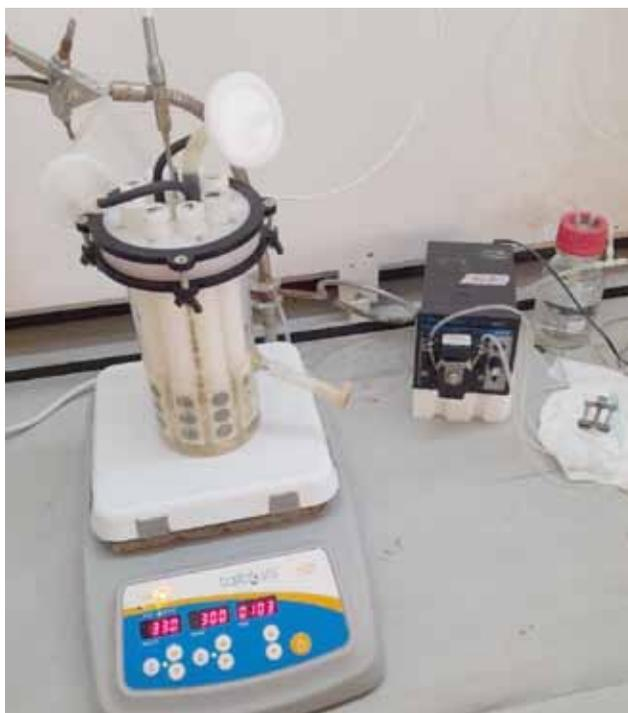
Figura 3. Imagen del reactor CDC en fase Batch.
