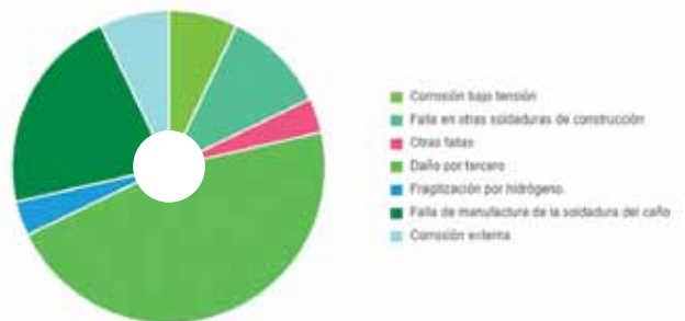
Figura 14. Diagrama de incidentes con orificios mayores a 110mm y rotura completa del ducto, para el período 2009-2023, discriminados por causa
