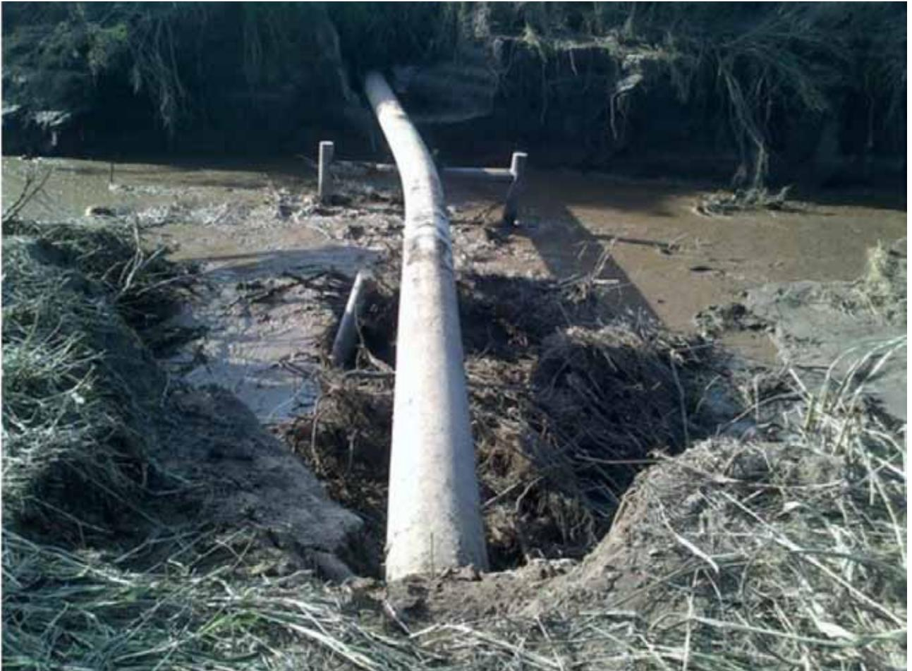
Figura 10. Flexión por arrastre en una cañería expuesta
