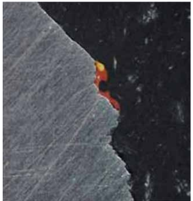
Figura 15. (X20) sección 2, defecto inicial con pintura roja, y traza de propagación en servicio
