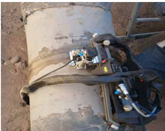
Paut: Indicaciones en soldadura.
