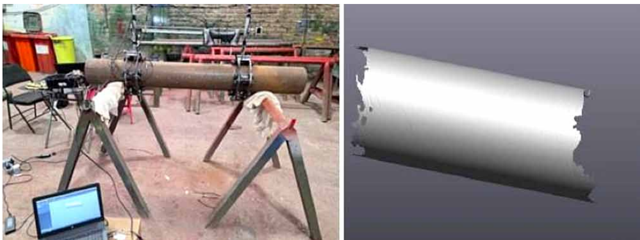
Figura 11. Resultado del escaneo utilizando el prototipo a) Prototipo montado sobre la superficie de la tubería b) Superficie escaneada de la tubería.
