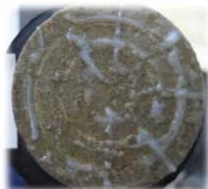
Figura 4. Núcleo de berea - cara de entrada.
